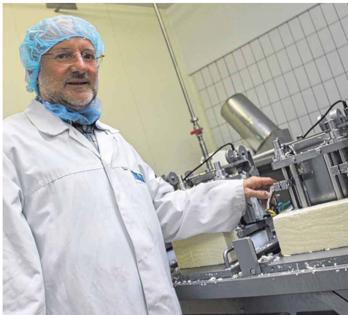
Aus groß wird klein: Bergpracht-Geschäftsführer Karl-Georg Geßler erklärt, wie mit dieser Maschine aus dem vorderen großen Käseblock Würfel geschnitten werden.
